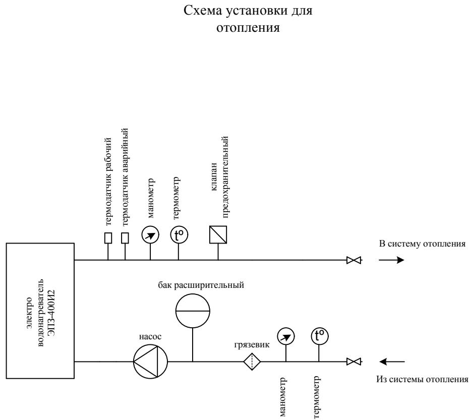
95°C, температура обратной воды (на входе в водонагреватель) должна быть близка к 70°C.
