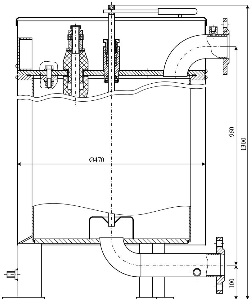
К верхнему патрубку крепится съемный патрубок с гнездами для датчиков температуры (регулирующего и аварийного) и предохранительным устройством с разрывной мембраной. На верхней крышке смонтированы элементы электродной группы.
