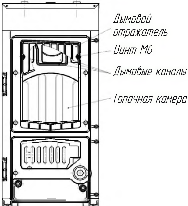
Рис. 16 Чистка дымовых каналов
