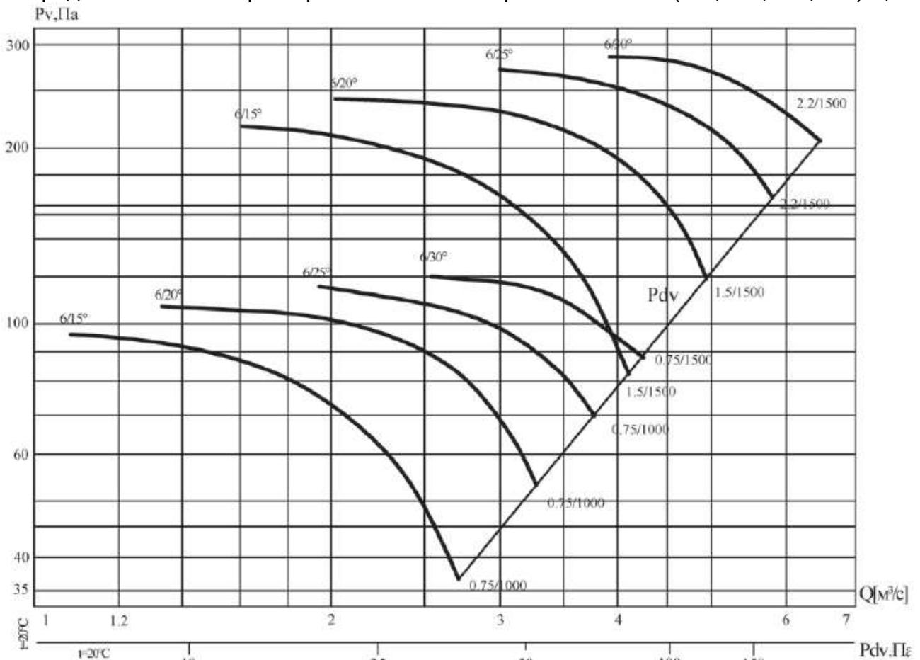
Аэродинамическая характеристика вентилятора В0 13-284-6/(15°, 20°, 25°, 30°)-7,1
