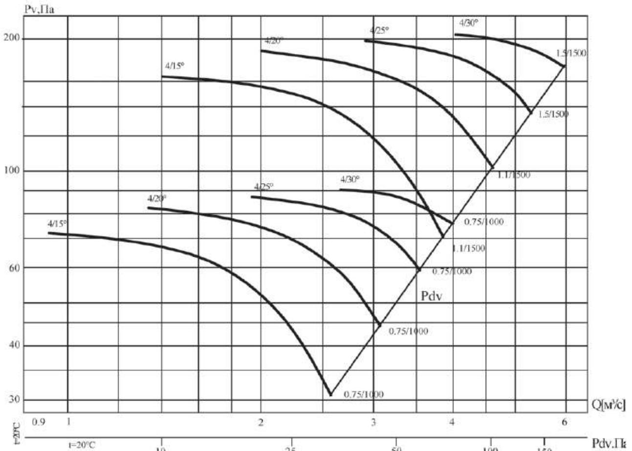
Аэродинамическая характеристика вентилятора В0 13-284-4/(15°, 20°, 25°, 30°)-7,1
