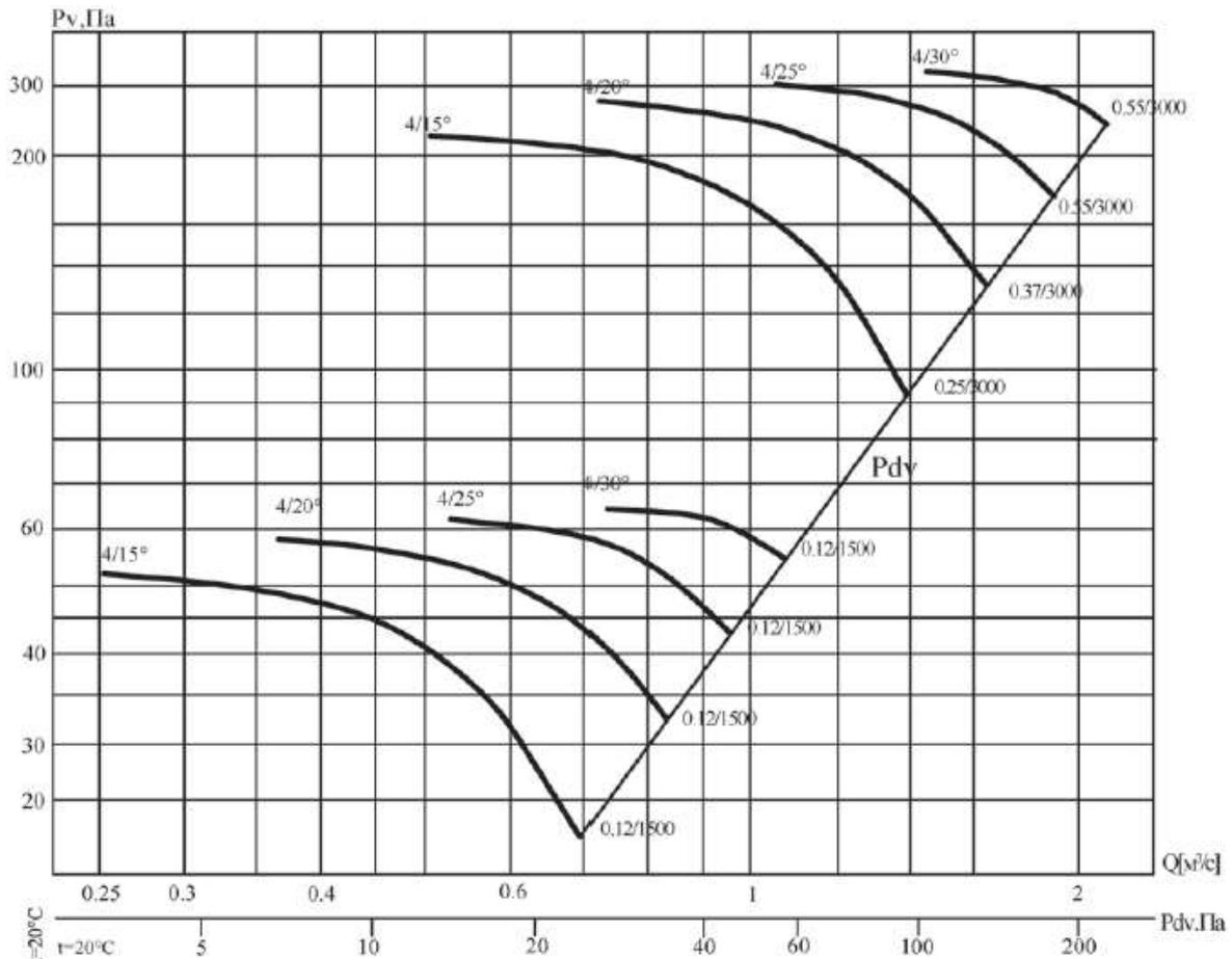
Аэродинамическая характеристика вентилятора В0 13-284-4/(15°, 20°, 25°, 30°)-4
