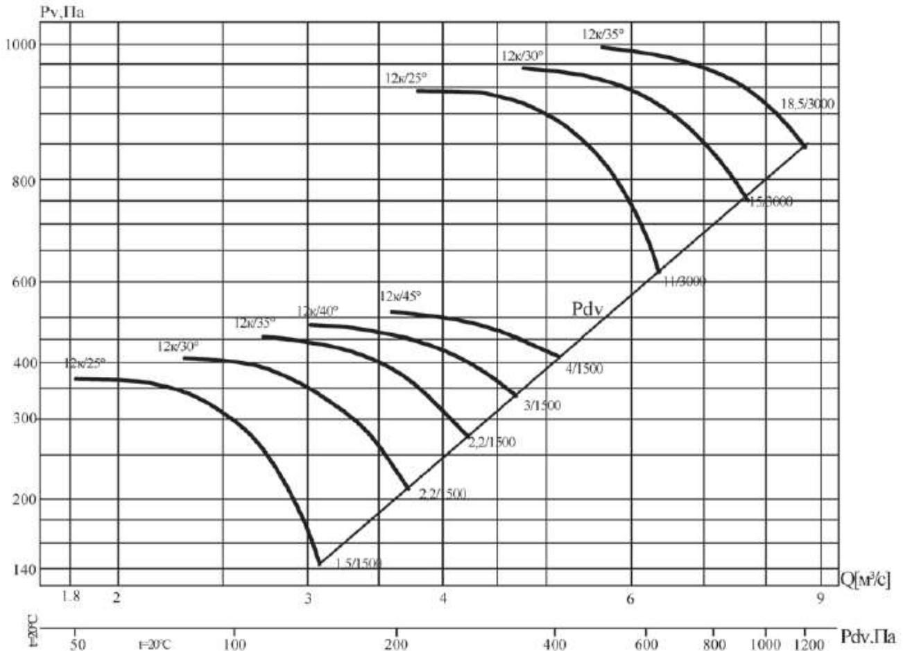
Аэродинамическая характеристика вентилятора В0 13-284-12к/(25°, 30°, 35°, 40°, 45°)-6,3
