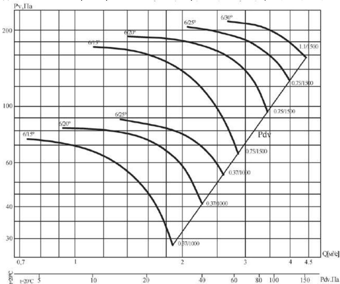
Аэродинамическая характеристика вентилятора В0 13-284-6/(15°, 20°, 25°, 30°)-6,3
