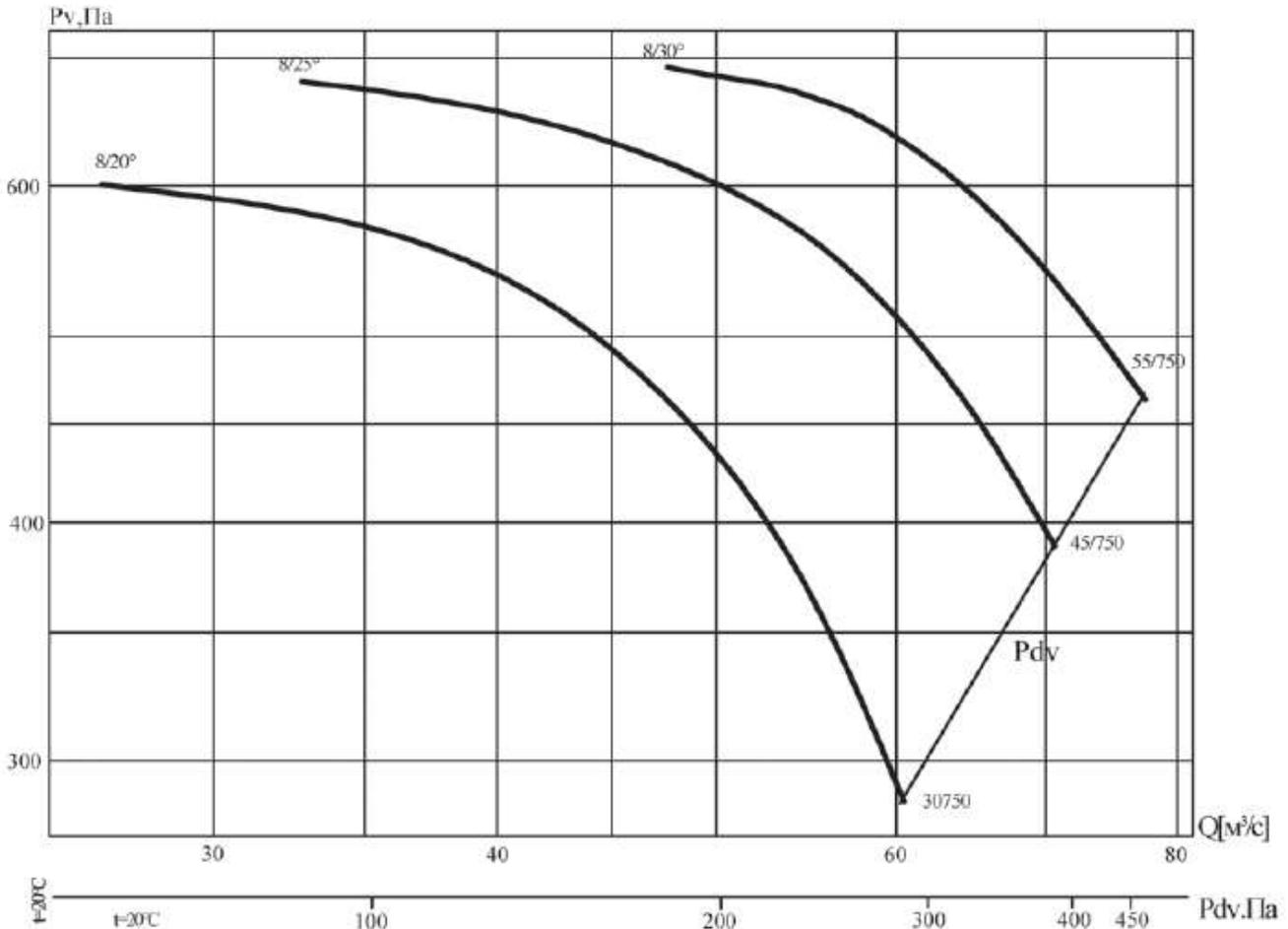
Аэродинамическая характеристика вентилятора В0 13-284-8/(20°, 25°, 30°)-20
