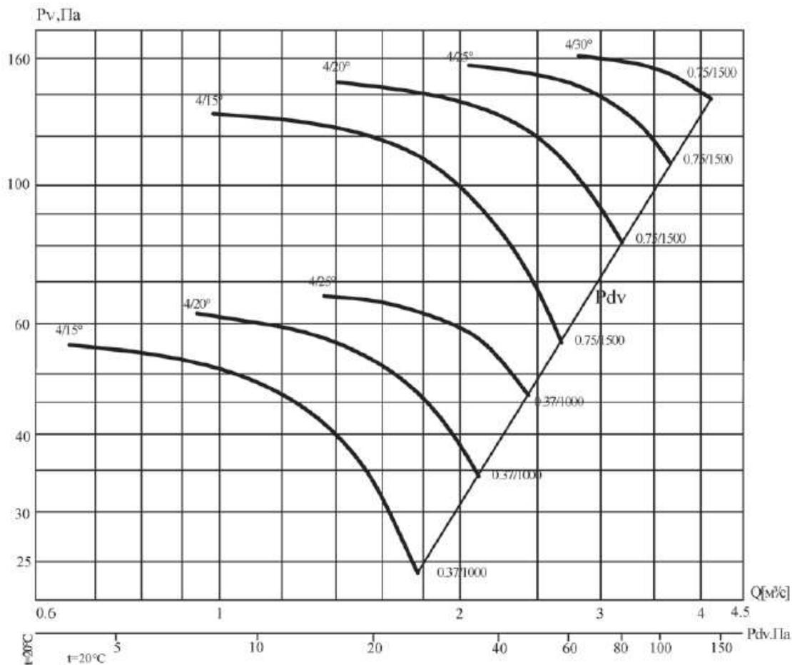
Аэродинамическая характеристика вентилятора В0 13-284-4/(15°, 20°, 25°, 30°)-6,3
