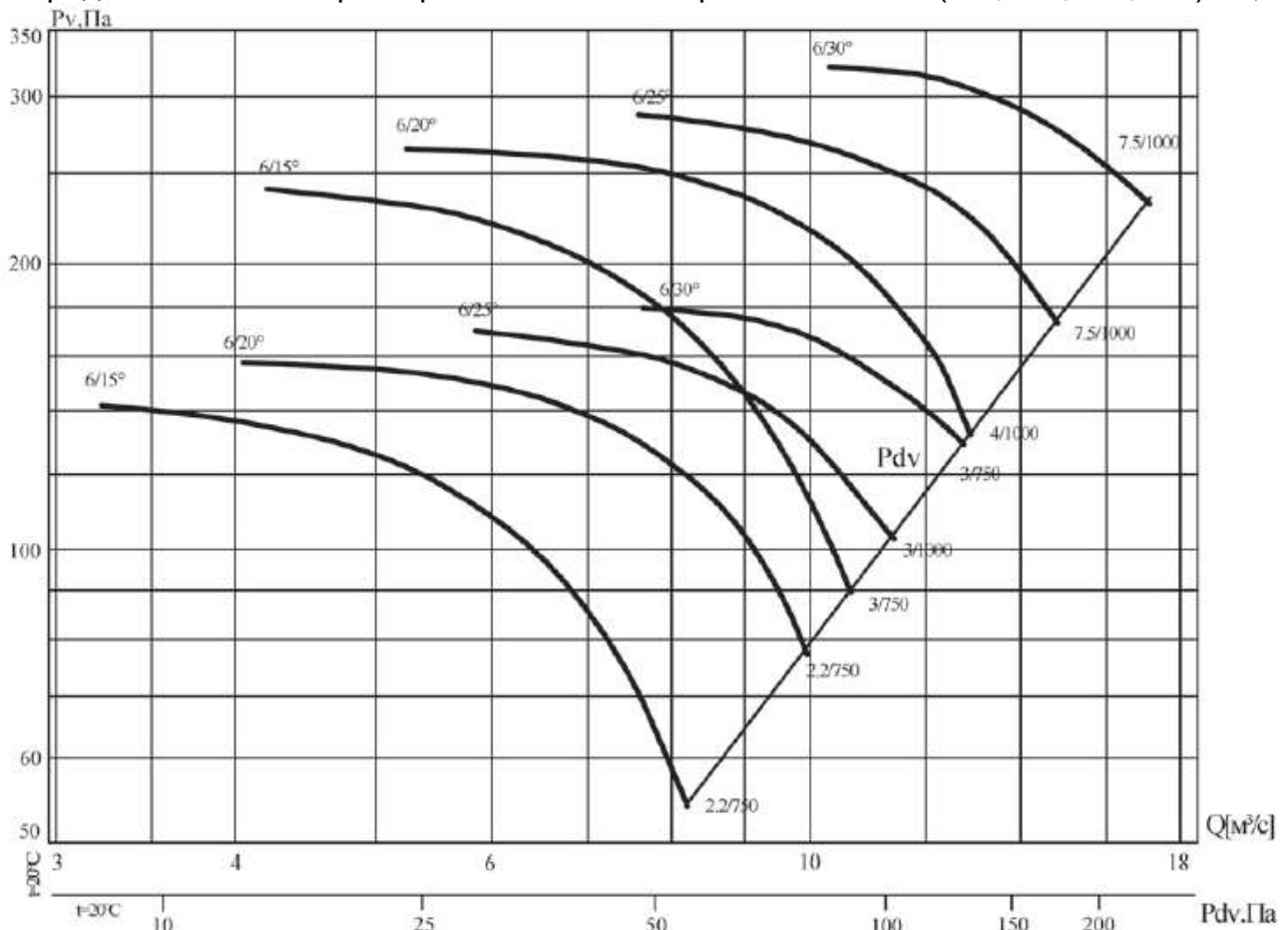
Аэродинамическая характеристика вентилятора В0 13-284-6/(15°, 20°, 25°, 30°)-11,2
