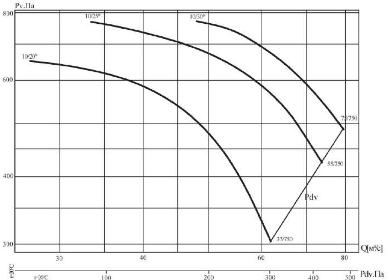
Аэродинамическая характеристика вентилятора В0 13-284-10/(20°, 25°, 30°)-20
