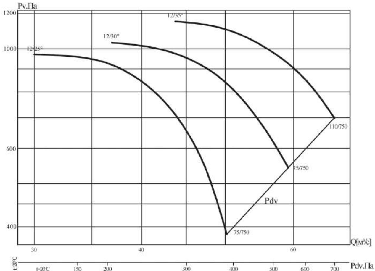
Аэродинамическая характеристика вентилятора В0 13-284-12к/(25°, 30°, 35°, 40°, 45°)-20
