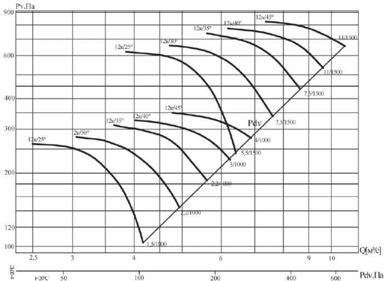
Аэродинамическая характеристика вентилятора В0 13-284-12к/(25°, 30°, 35°, 40°, 45°)-8
