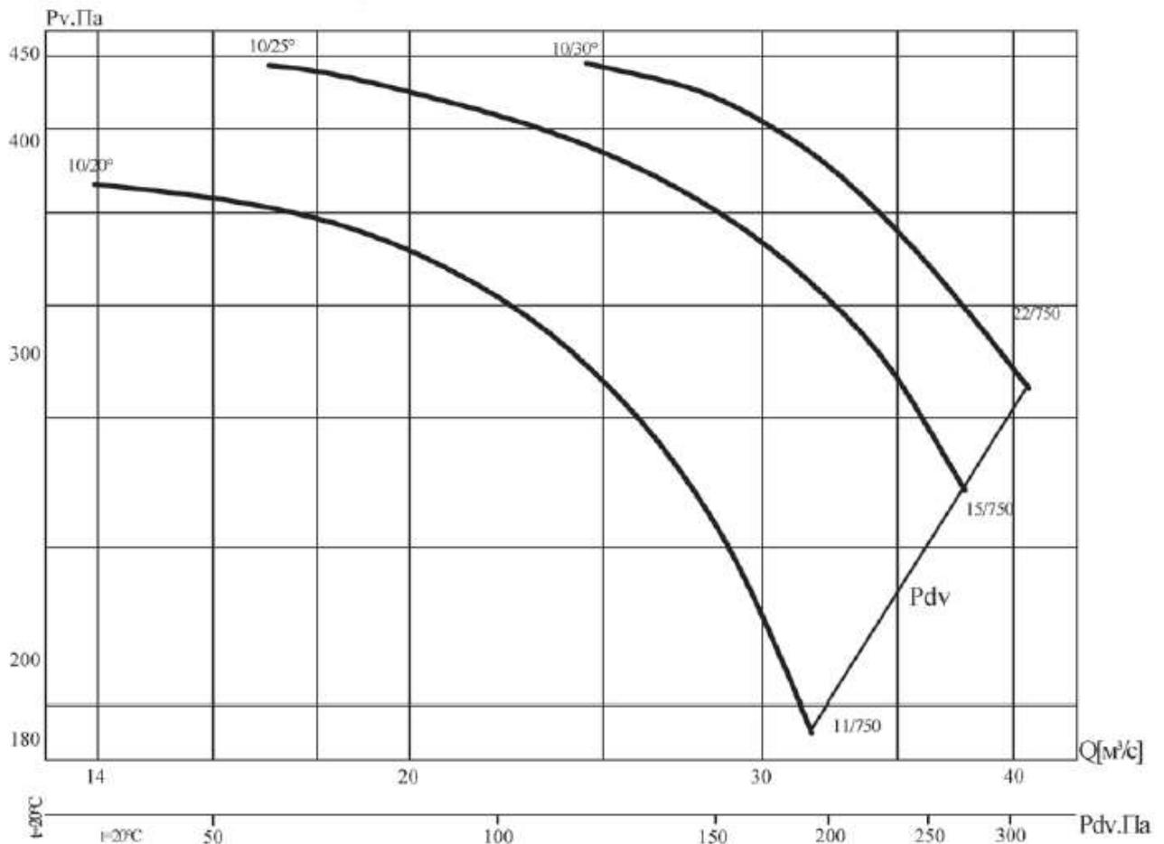
Аэродинамическая характеристика вентилятора В0 13-284-10/(20°, 25°, 30°)-16
