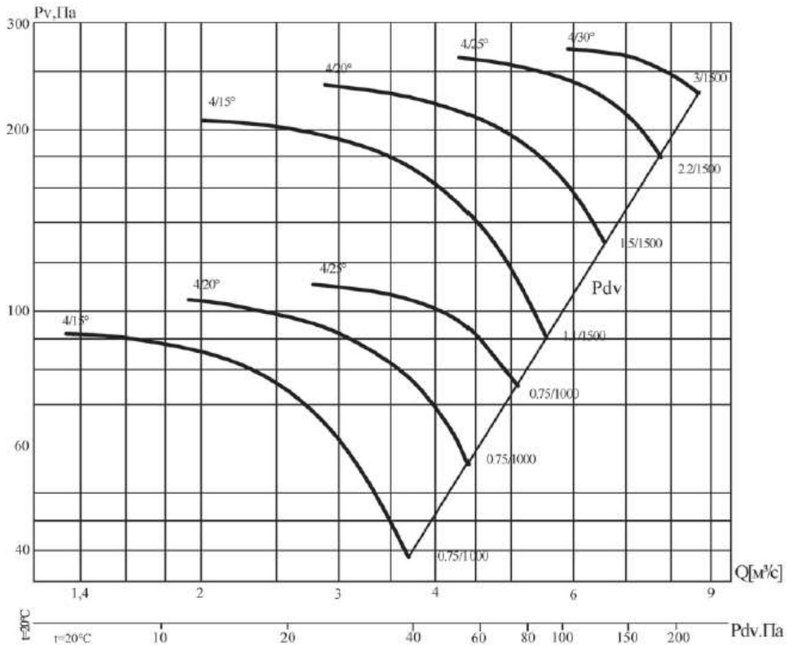
Аэродинамическая характеристика вентилятора В0 13-284-4/(15°, 20°, 25°, 30°)-8
