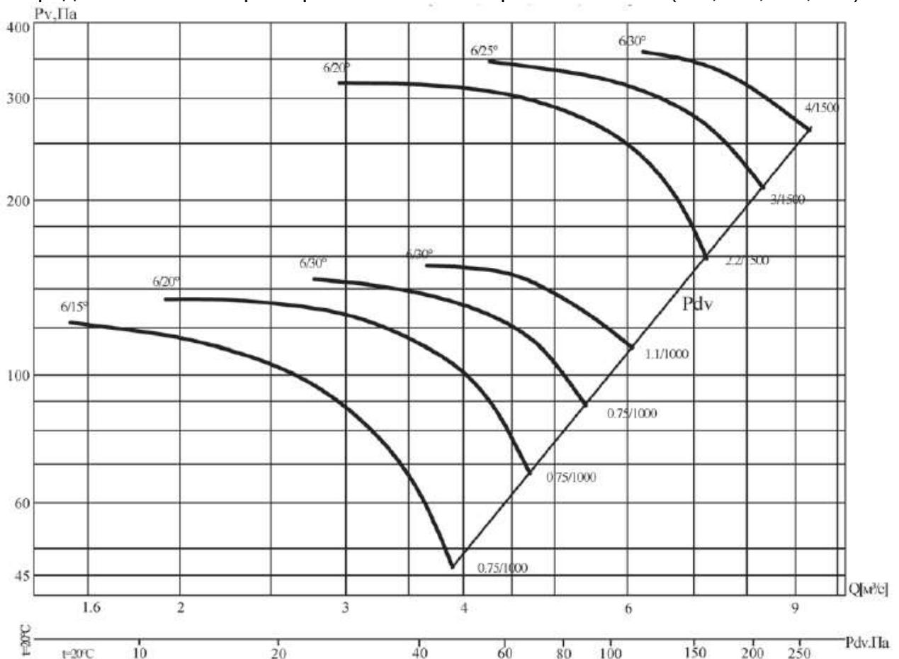
Аэродинамическая характеристика вентилятора В0 13-284-6/(15°, 20°, 25°, 30°)-8
