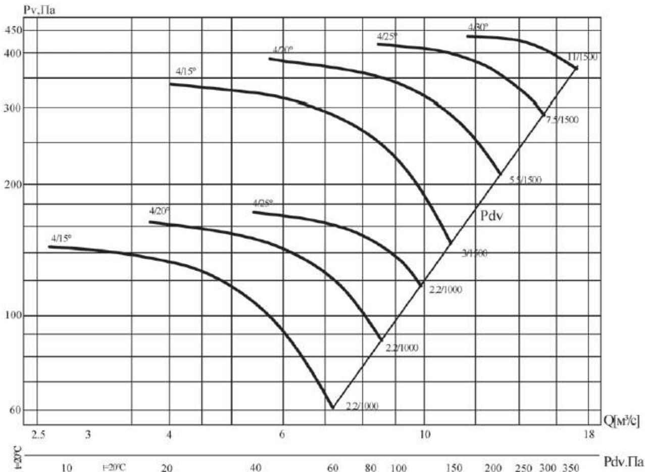
Аэродинамическая характеристика вентилятора В0 13-284-4/(15°, 20°, 25°, 30°)-10
