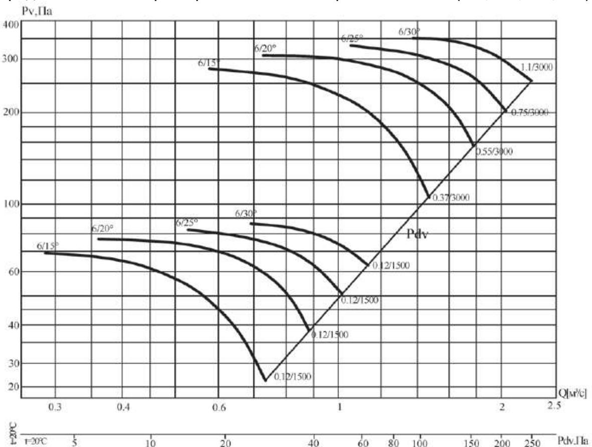
Аэродинамическая характеристика вентилятора В0 13-284-6/(15°, 20°, 25°, 30°)-4
