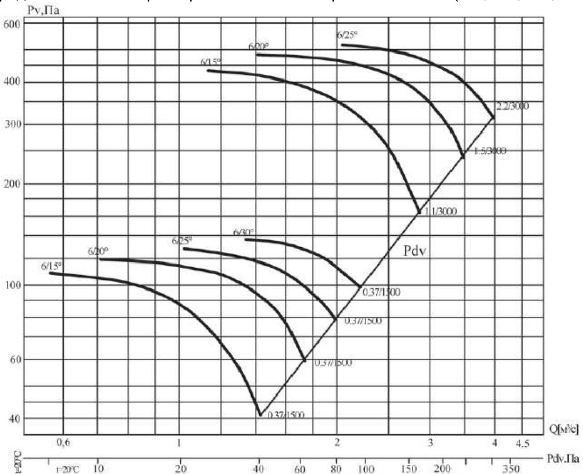
Аэродинамическая характеристика вентилятора В0 13-284-6/(15°, 20°, 25°, 30°)-5
