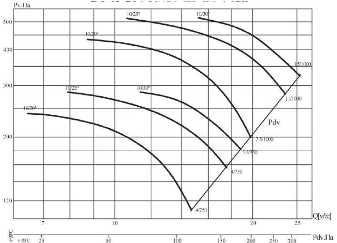
Аэродинамическая характеристика вентилятора В0 13-284-10/(20°, 25°, 30°)-12,5
