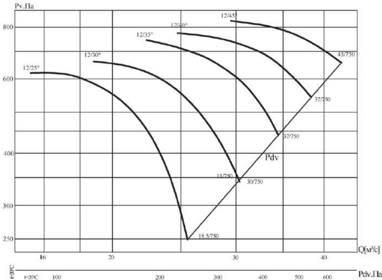
Аэродинамическая характеристика вентилятора В0 13-284-12к/(25°, 30°, 35°, 40°, 45°)-16
