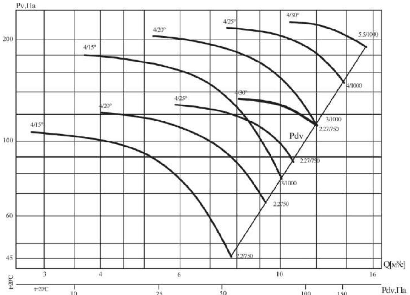
Аэродинамическая характеристика вентилятора В0 13-284-4/(15°, 20°, 25°, 30°)-11,2
