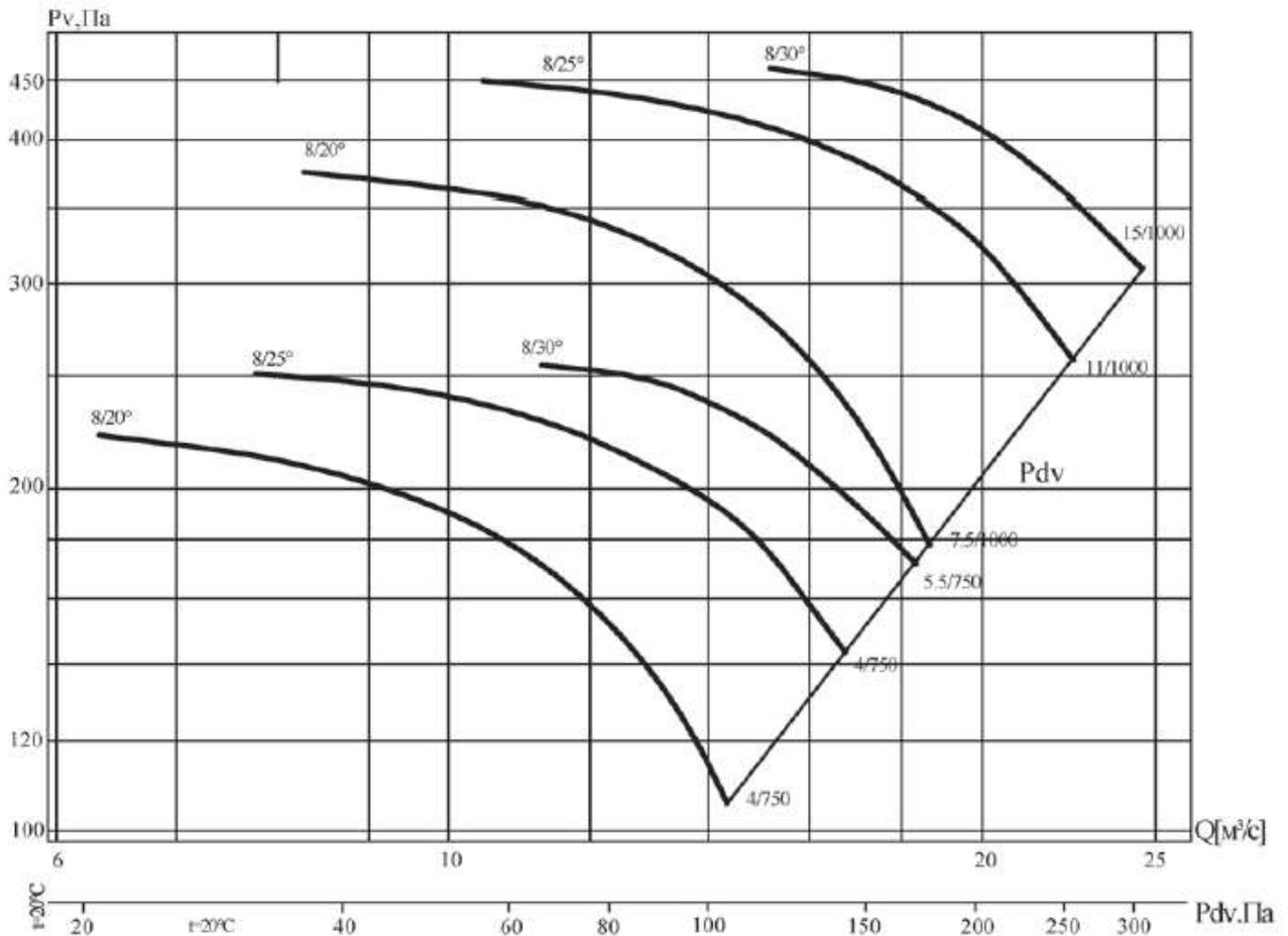
Аэродинамическая характеристика вентилятора В0 13-284-8/( 20°, 25°, 30°)-12,5
