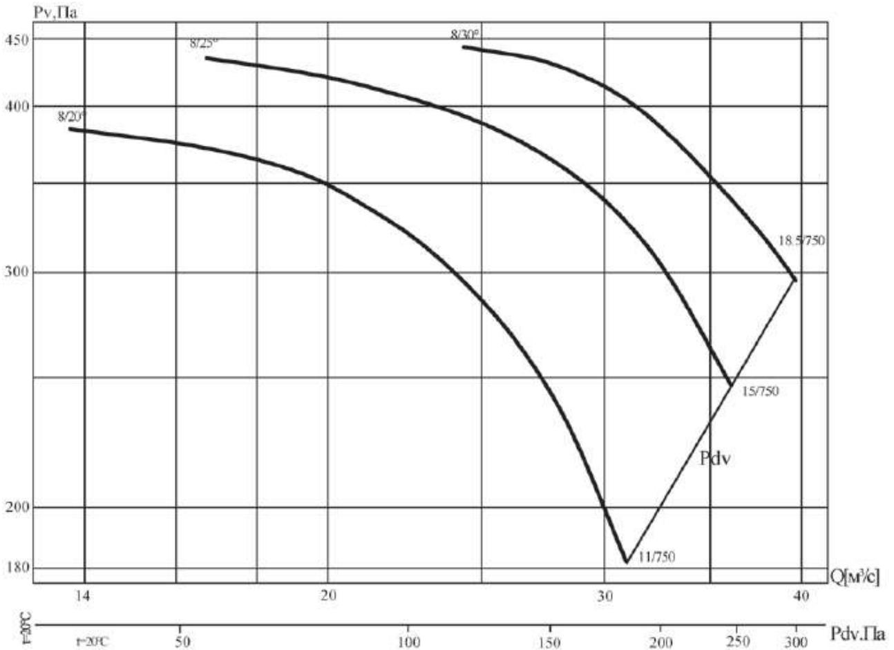
Аэродинамическая характеристика вентилятора В0 13-284-8/(20°, 25°, 30°)-16
