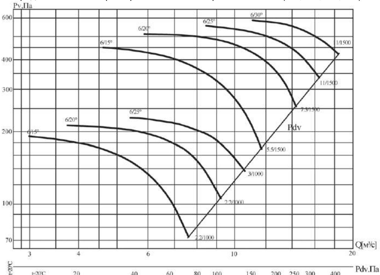
Аэродинамическая характеристика вентилятора В0 13-284-6/(15°, 20°, 25°, 30°)-10
