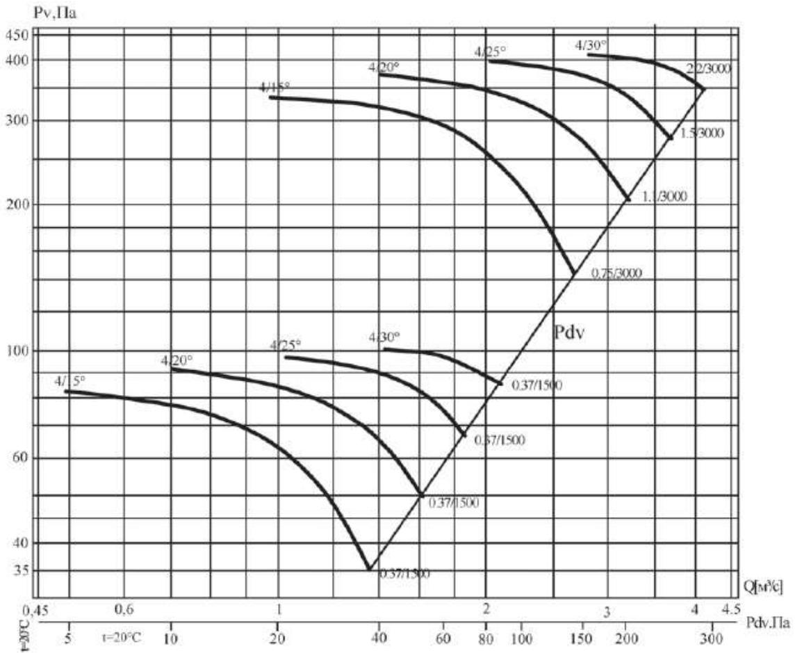
Аэродинамическая характеристика вентилятора В0 13-284-4/(15°, 20°, 25°, 30°)-5
