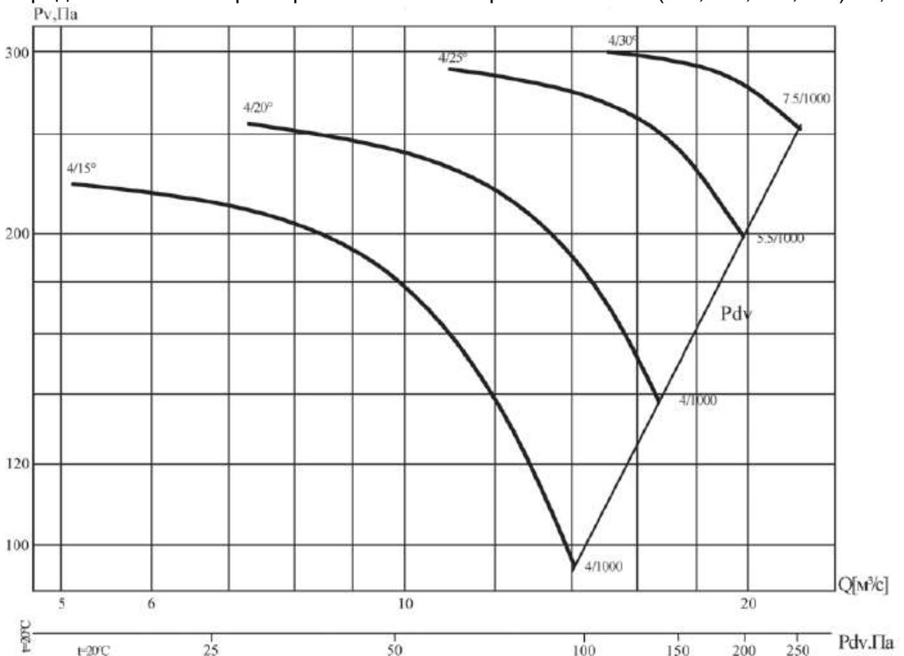
Аэродинамическая характеристика вентилятора В0 13-284-4/(15°, 20°, 25°, 30°)-12,5
