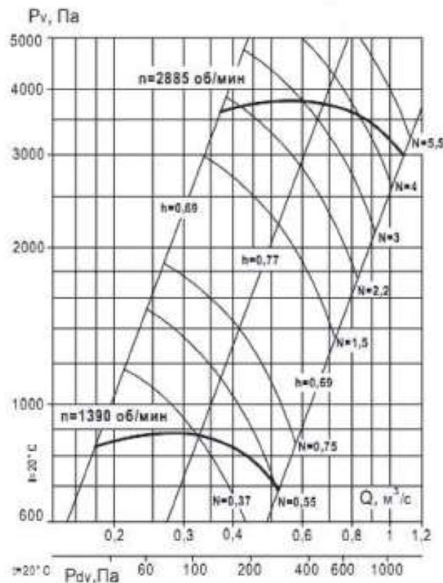
Аэродинамическая характеристика вентилятора ВР 132-30 №4,5 (1 и 5 исполнение)
