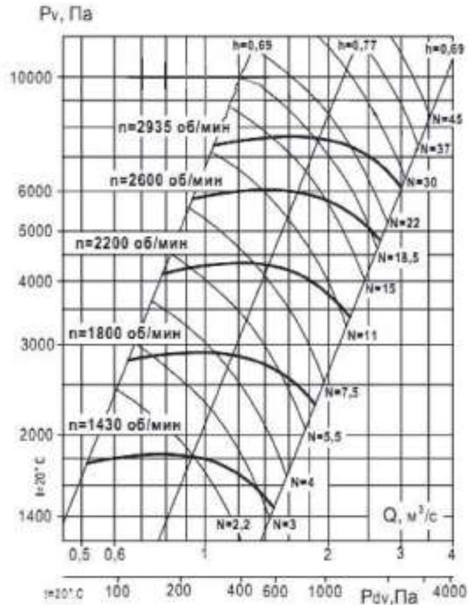
Аэродинамическая характеристика вентилятора ВР 132-30 №6,3 (1 и 5 исполнение)
