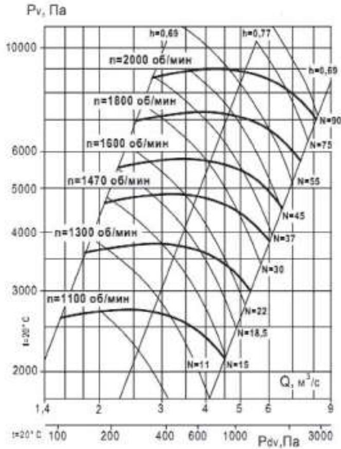
Аэродинамическая характеристика вентилятора ВР 132-30 №10 (1 и 5 исполнение)
