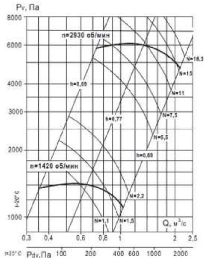
Аэродинамическая характеристика вентилятора ВР 132-30 №5,6 (1 и 5 исполнение)
