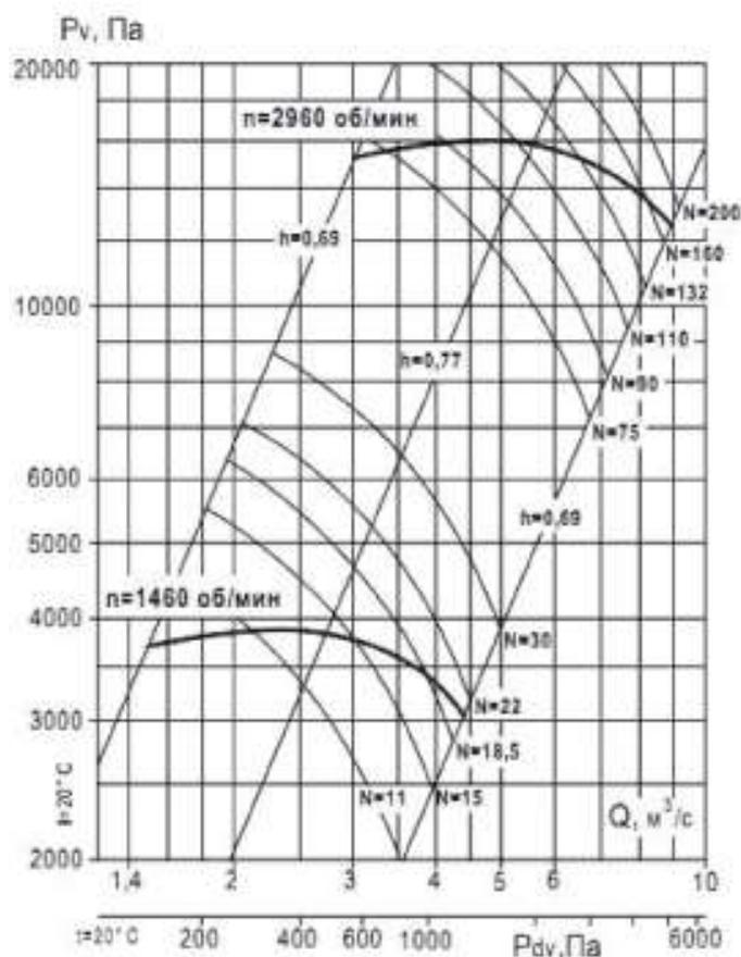
Аэродинамическая характеристика вентилятора ВР 132-30 №9 (1 и 5 исполнение)
