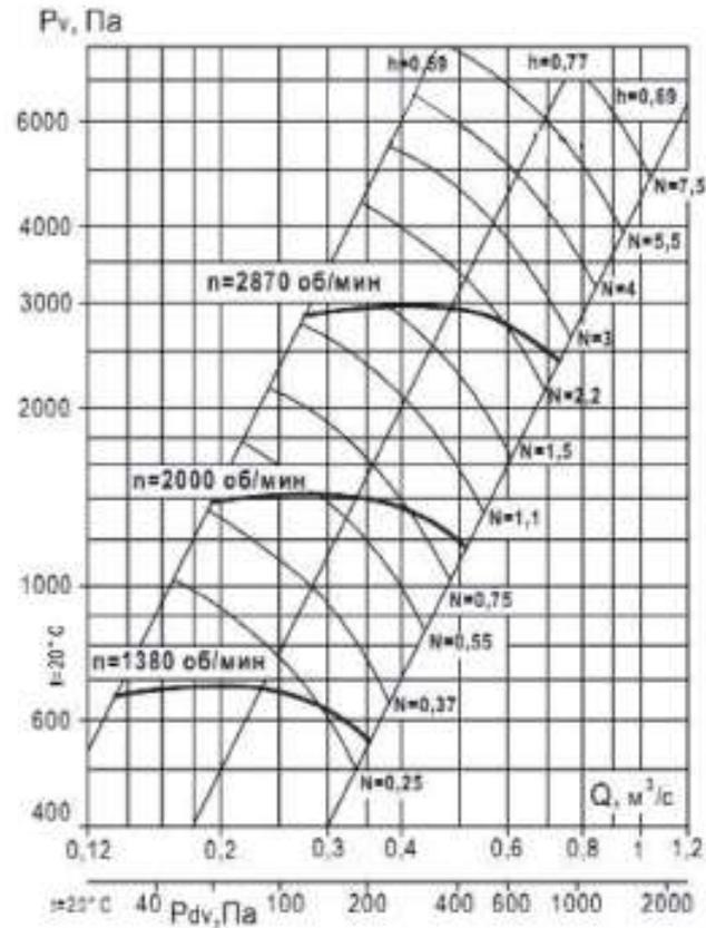
Аэродинамическая характеристика вентилятора ВР 132-30 №4 (1 и 5 исполнение)
