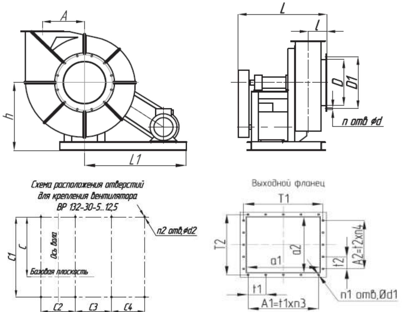
РИС. 2. Габаритные и присоединительные размеры вентиляторов ВР 132-30 исп-5
