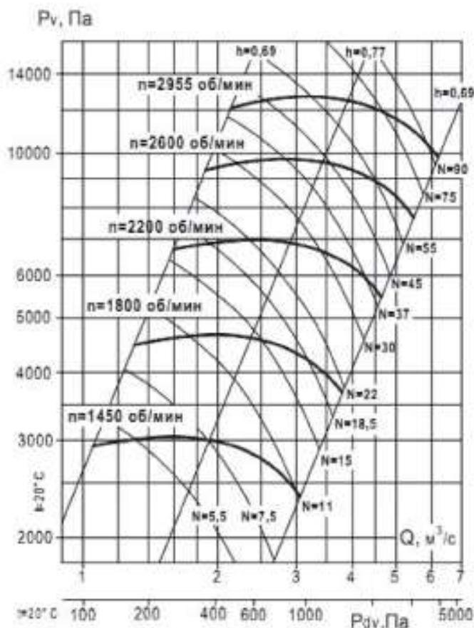
Аэродинамическая характеристика вентилятора ВР 132-30 №8 (1 и 5 исполнение)
