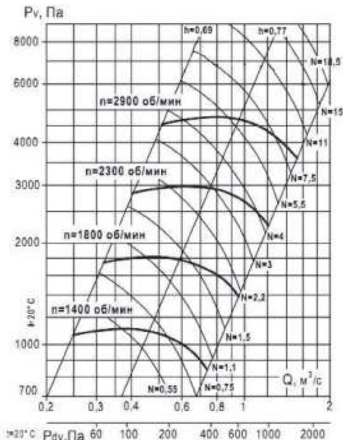
Аэродинамическая характеристика вентилятора ВР 132-30 №5 (1 и 5 исполнение)
