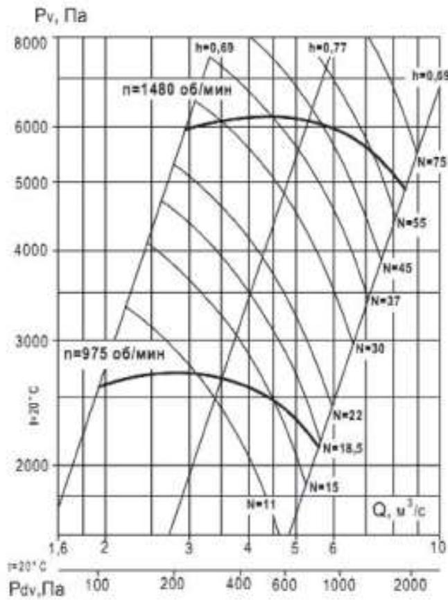
Аэродинамическая характеристика вентилятора ВР 132-30 №11,2 (1 и 5 исполнение)
