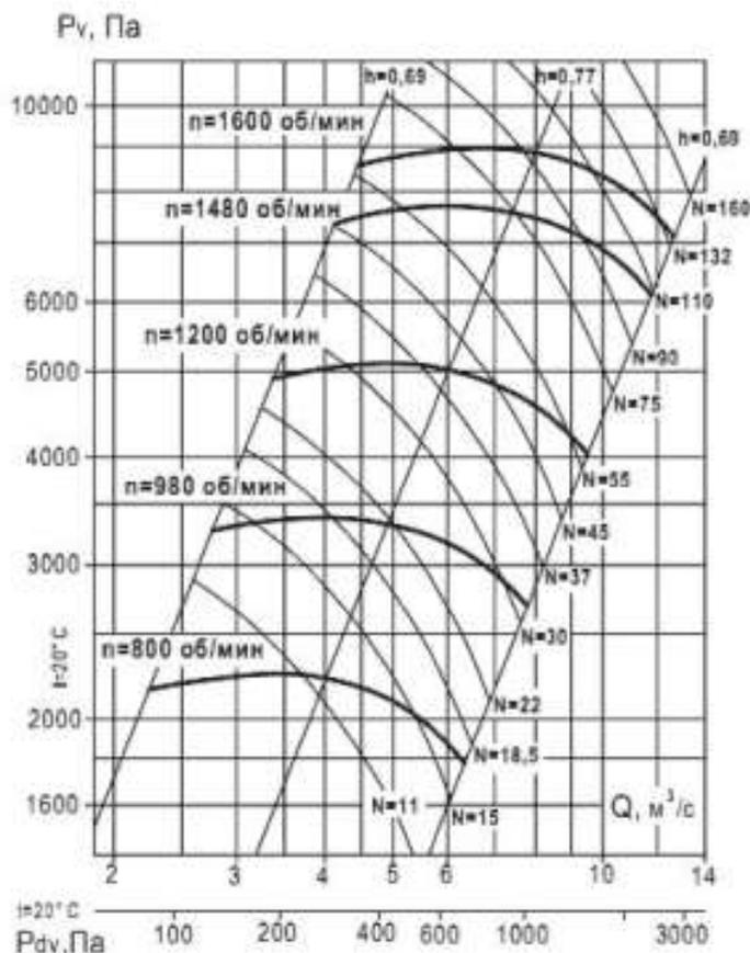
Аэродинамическая характеристика вентилятора ВР 132-30 №12,5 (1 и 5 исполнение)
