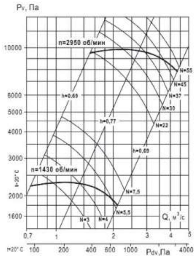
Аэродинамическая характеристика вентилятора ВР 132-30 №7,1 (1 и 5 исполнение)
